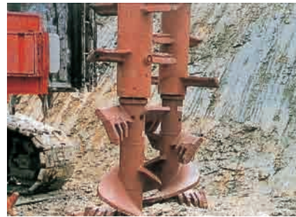
掘削・攪拌部
